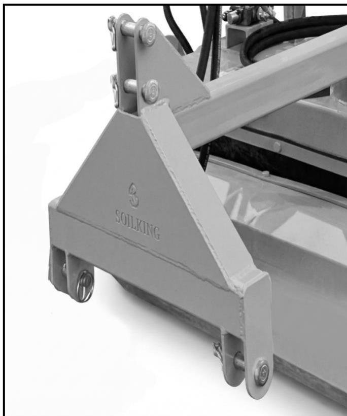
Рис. 4 Положение присоединительных элементов машины для трёхточечной навески категории I
